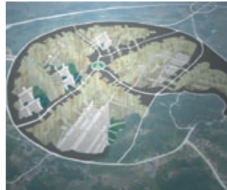
創造都市計画イメージベース (直径2kmを約60m掘り下げ地底部に新たな都市を計画する)
