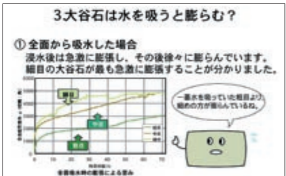
吸水による大谷石の膨張
